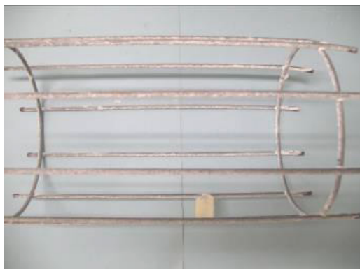
Análisis de la resistencia a la corrosión en niebla salina. Bezinal 2000 claseB tras 24 horas de exposición.
