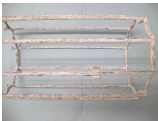
Análisis de la resistencia a la corrosión en niebla salina. Galvanizado normal tras 24 horas de exposición.
